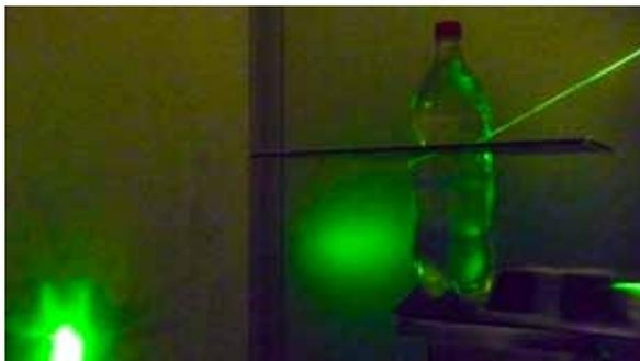
Abb.36 Strahlengang durch eine mit Wasser voll gefüllten PET-Flasche bei tiefem Sonnenstand
