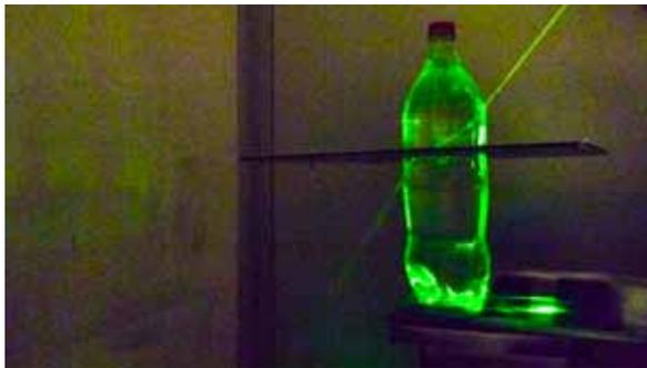
Abb.35 Strahlengang durch eine mit Wasser voll gefüllten PET-Flasche bei hohem Sonnenstand
